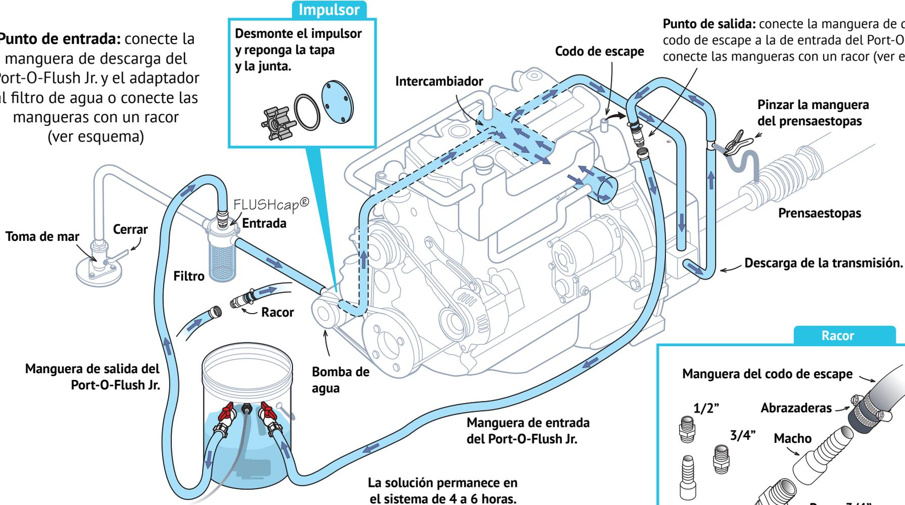
**Verter la solución de Barnacle Buster concentrado y agua en la cuba de la bomba (Port-O-Flush Jr.)**
